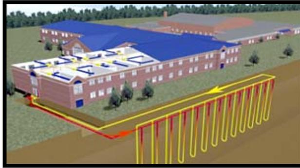
Figure 9 - Geothermal Diagram<sup>67</sup>
